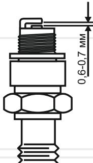
Необхідно регулярно чистити та перевіряти працездатність свічки запалювання. Несправна і брудна свічка, або якщо свічка має нагар, стає причиною важкого запуску і поганої роботи двигуна мотокоси.
