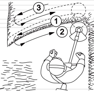
При скошуванні ділянок території, на яких відсутні перешкоди, поступово ведіть мотокосу з боку в бік, намагаючись при цьому утримувати розальну частину виробу на одній висоті від землі. Для визначення бажаної висоти скошування, здійсніть пробне скошування. При скошуванні широких ділянок території, поділіть зону роботи на сектори.
