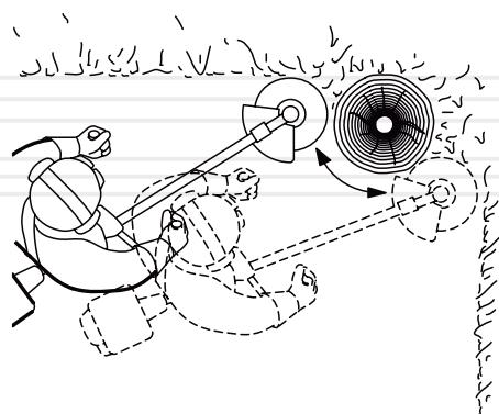
Під час обробки ділянок місцевості навколо дерев, ведіть мотокосу дуже повільно і гранично обережно, щоб ліска не торкалася стовбура дерева і при цьому не змогла пошкодити кору. Кожне дерево обходьте зліва направо по колу (див. малюнок 9).
