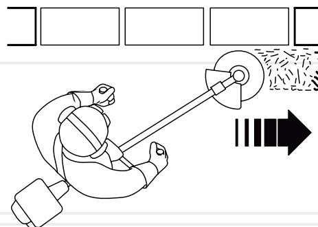
При скошуванні трави на ділянках, які прилягають до огорож, парканів, кам'яних стін та фундаментів, мотокосу ведіть дуже повільно в напрямку, як зображене на малюнку 8, намагаючись зрізати траву якнайближче до перешкоди. При цьому намагайтесь, щоб ліска не торкалася до цих перешкод, оскільки може відбутися обрив ліски.
