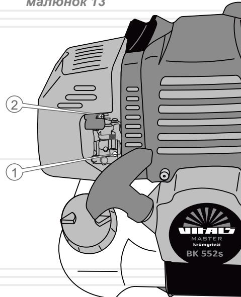
1. Регулювальний гвинт подачі палива.
